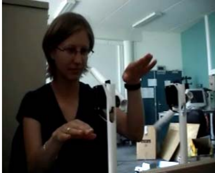
Fig. 4.1: L'humain est face au robot (ADRIANA) muni de deux bras à un degré de liberté et d'une caméra. Lorsque l'humain respectivement lève et baisse l'un ou l'autre bras, le robot respectivement lève ou baisse aléatoirement l'un ou l'autre de ses bras. L'humain a pour consigne de faire apprendre au robot à bouger le bras qui est du même côté (en miroir) que celui que lui, l'humain, bouge.
